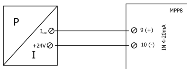
Rysunek 24. Przykładowe podłączenie czujnika ciśnienia z przetwornikiem serii MPP®8 wyposażonego w wejście prądowe A (aktywne).
